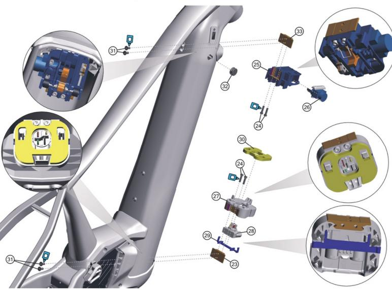
Hinweis: Bei den Schrauben muss mittelfeste Gewindesicherung verwendet werden. Rote Flächen müssen gefettet werden.
