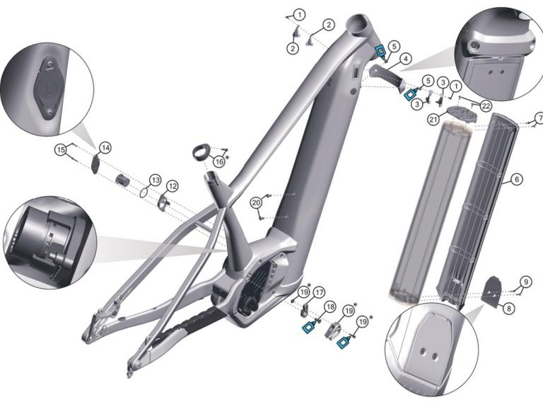
Hinweis: Bei den Schrauben muss mittelfeste Gewindesicherung verwendet werden.
