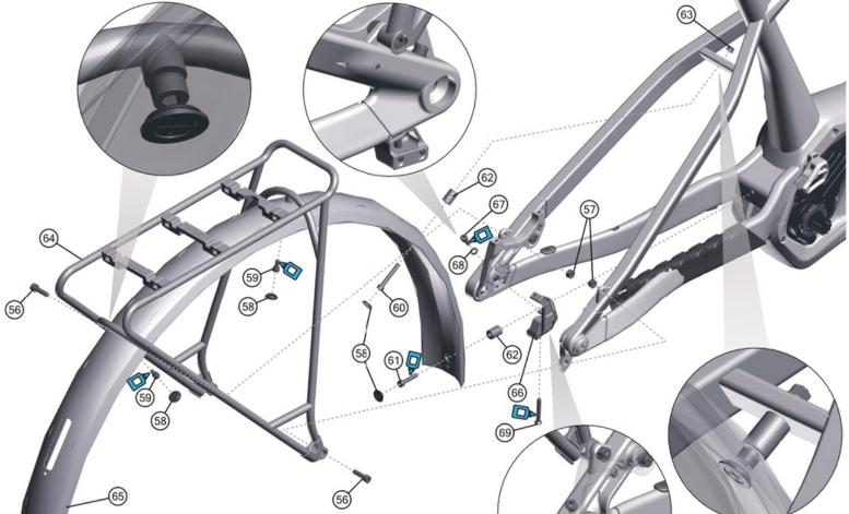
Hinweis: Bei den Schrauben muss mittelfeste Gewindesicherung verwendet werden. Rote Flächen müssen gefettet werden.
