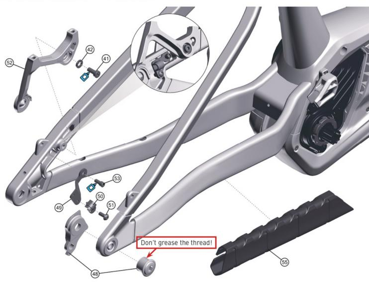
Hinweis: Bei den Schrauben muss mittelfeste Gewindesicherung verwendet werden. Rote Flächen müssen gefettet werden.
